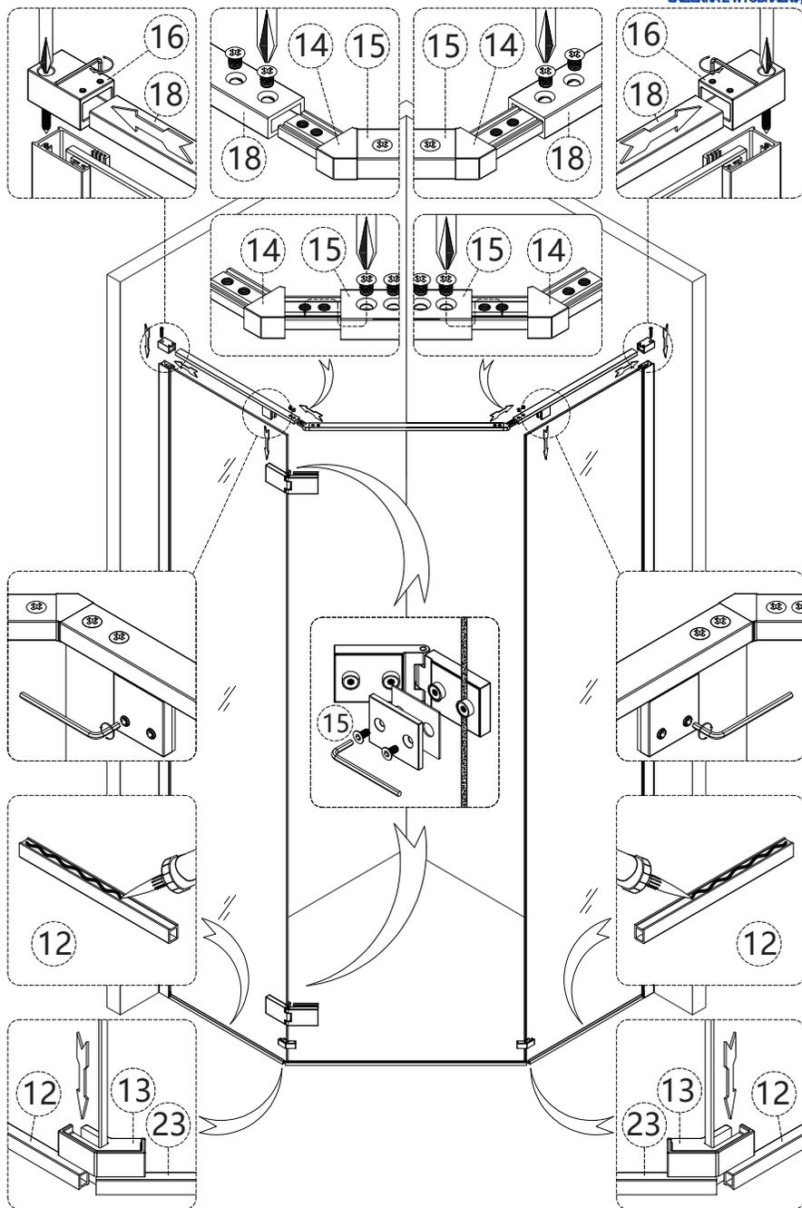
Vissez le cadre de la cabine avec les éléments 16, 18, 14 et 15 et vissez aux profils muraux (01) et aux vitres fixes (03, 19).
