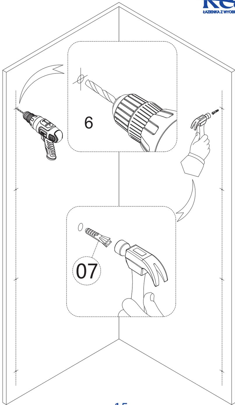
Percez les trous de montage et insérez les boulons (07).
