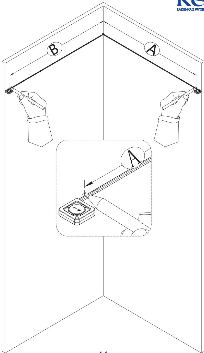
Mesurez les dimensions "A" et "B" respectivement.
